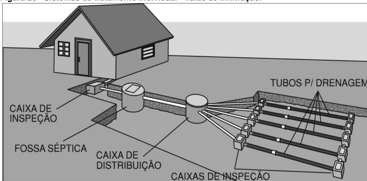
Figura 26 - Sistemas de tratamento individual- Valas de Infiltração.
